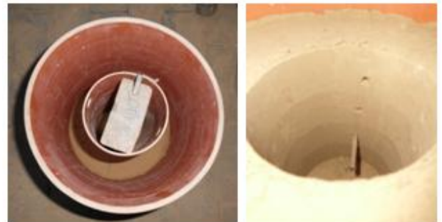
Abb. 3: Aufbau zum Erstellen der Ringschicht (links) und bohren der "Dichtefallen" (rechts)
